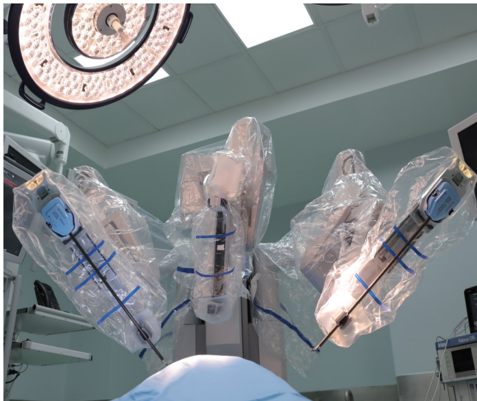
Figura 1.4 Robot para cirugía mínimamente invasiva de 3 brazos (autor: Wikimedia por Hospitalhoms).
